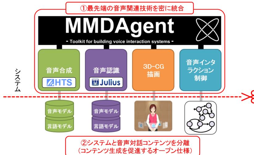
図 4. 音声インタラクションシステム構築ツールキット MMDAgent
